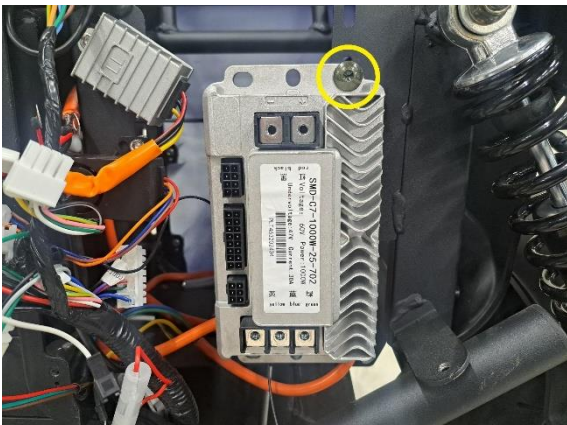
Irrota ohjainlaitteen kiinnityspultit (kuusiokoloavain 5 mm) ja vastapuolen mutteri (kiintoavain 10 mm).
