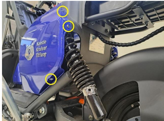
Irrota istuimen vasemmanpuoleisen alasivumuovin kiinnitysruuvit (ristipäämeisseli ph2).
