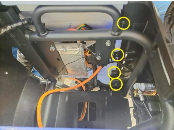
Irrota istuimen vasemmanpuoleisen alasivumuovin kiinnitysruuvit (ristipäämeisseli ph2).
